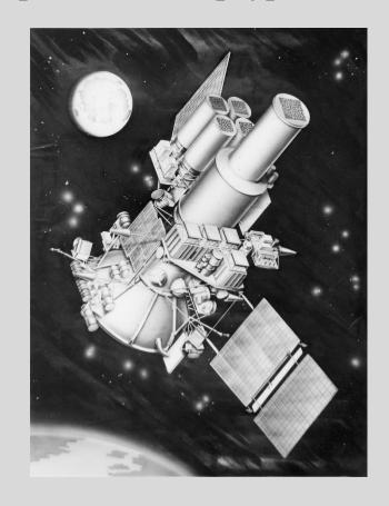
В состав космической астрофизической обсерватории «Гранат» вошли: французский гамма-телескоп Sigma с кодированной апертурой, рентгеновский телескоп с кодированной апертурой АРТ-П и другие приборы.
