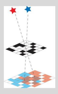
Принцип восстановления изображение в системах с кодирующей апертурой основан на том, что источники света в разных, относительно маски, положениях создают на приемнике излучения различную конфигурацию теней. Обработка положения полученных теней впоследствии позволяет восстановить изображение
