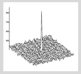
Поток источника излучения «размазывается» кодирующей апертурой практически на весь фотоприемник
