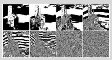
В нашем компьютере описание значений каждого пикселя по уровням получаемого полутонового изображения составляют из соответствующих разрядов их двоичного представления.
