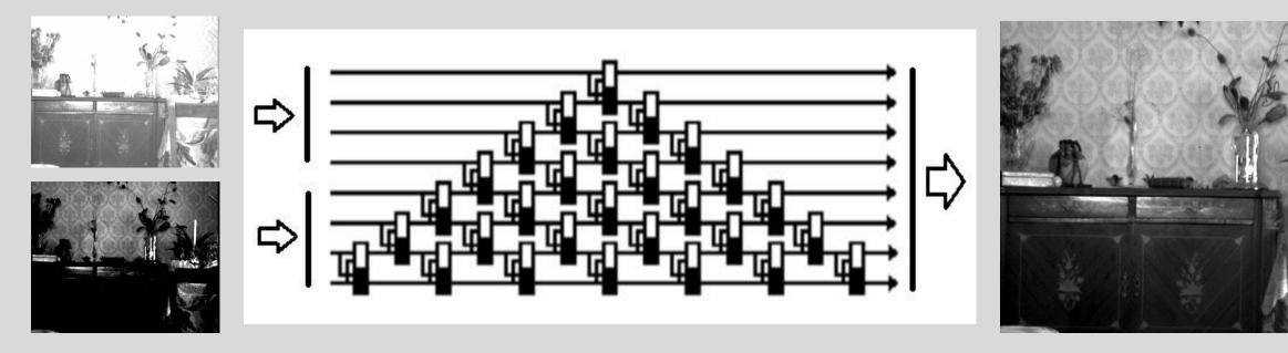
На входе два изображения с взаимно дополняющими градационными характеристиками, а на выходе суммарное изображение, как результат сортировки их составляющих по квантованным уровням.
